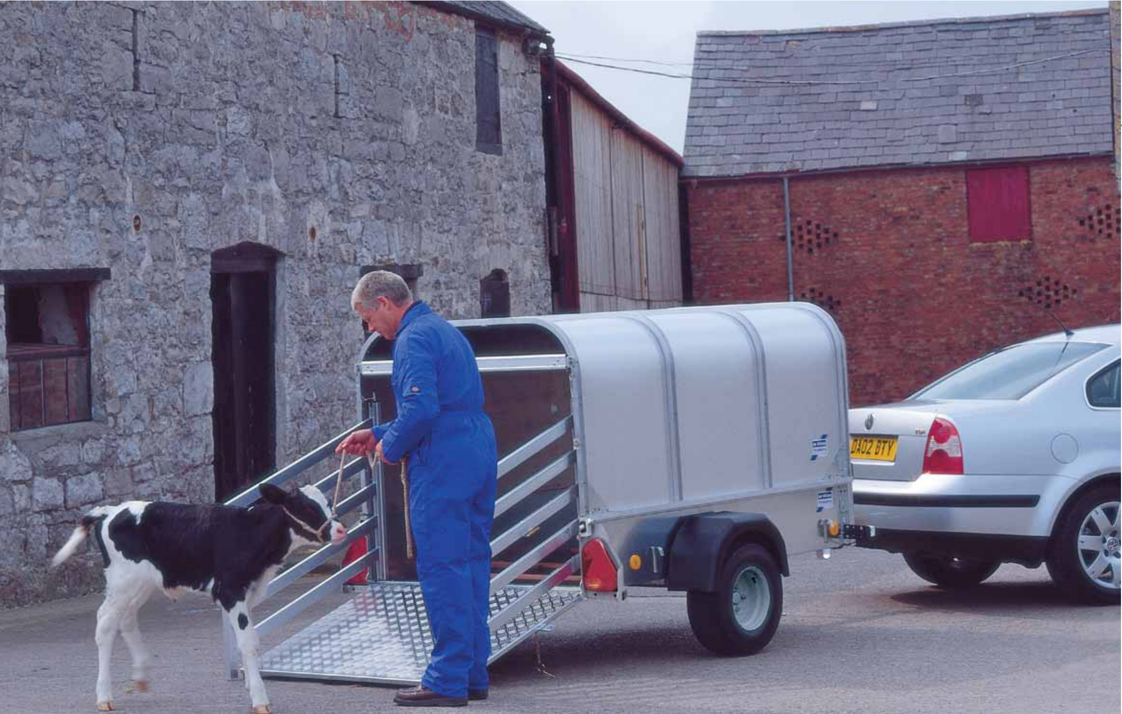
P6e Bétaillère, équipée de pneus 20.5 x 8-10 (750kg+)
