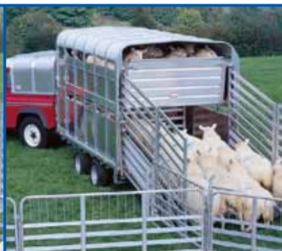
Le pont EasyLoad™ a été abaissé pour charger l'étage inférieur.
