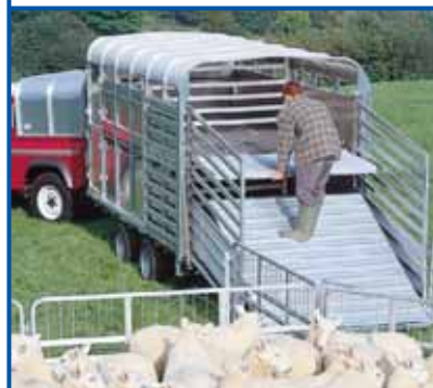
Pont EasyLoad™ déployé et barrière arrière baissée.
