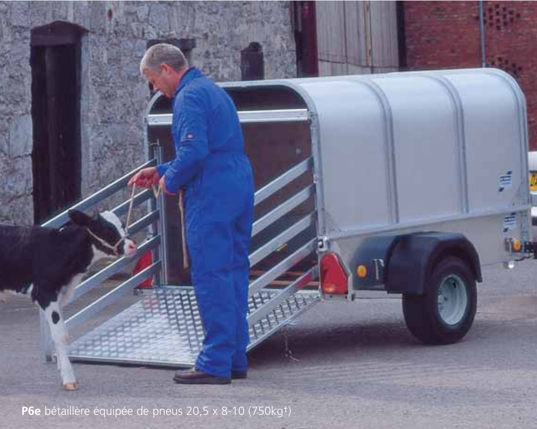
P6e équipée des options pont porte, rehausses de ridelles grillagées et pneus 20,5 x 8-10 (750kg†)
