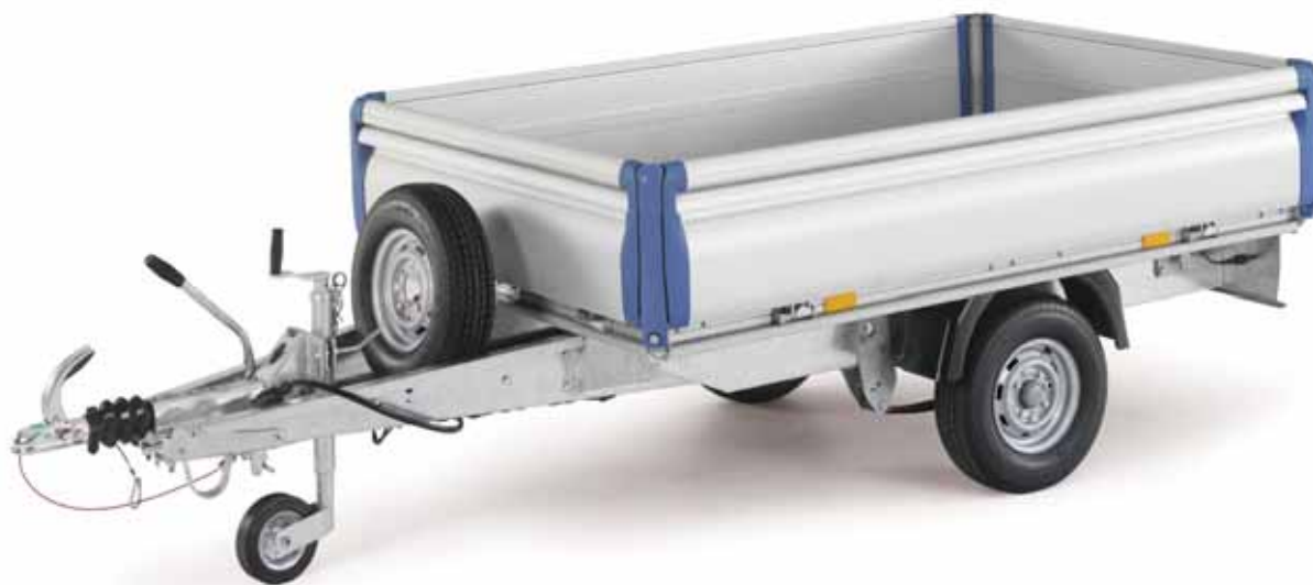
EL101-2012 avec en option ridelles latérales, avant et arrière, en aluminium à fermeture automatique.
