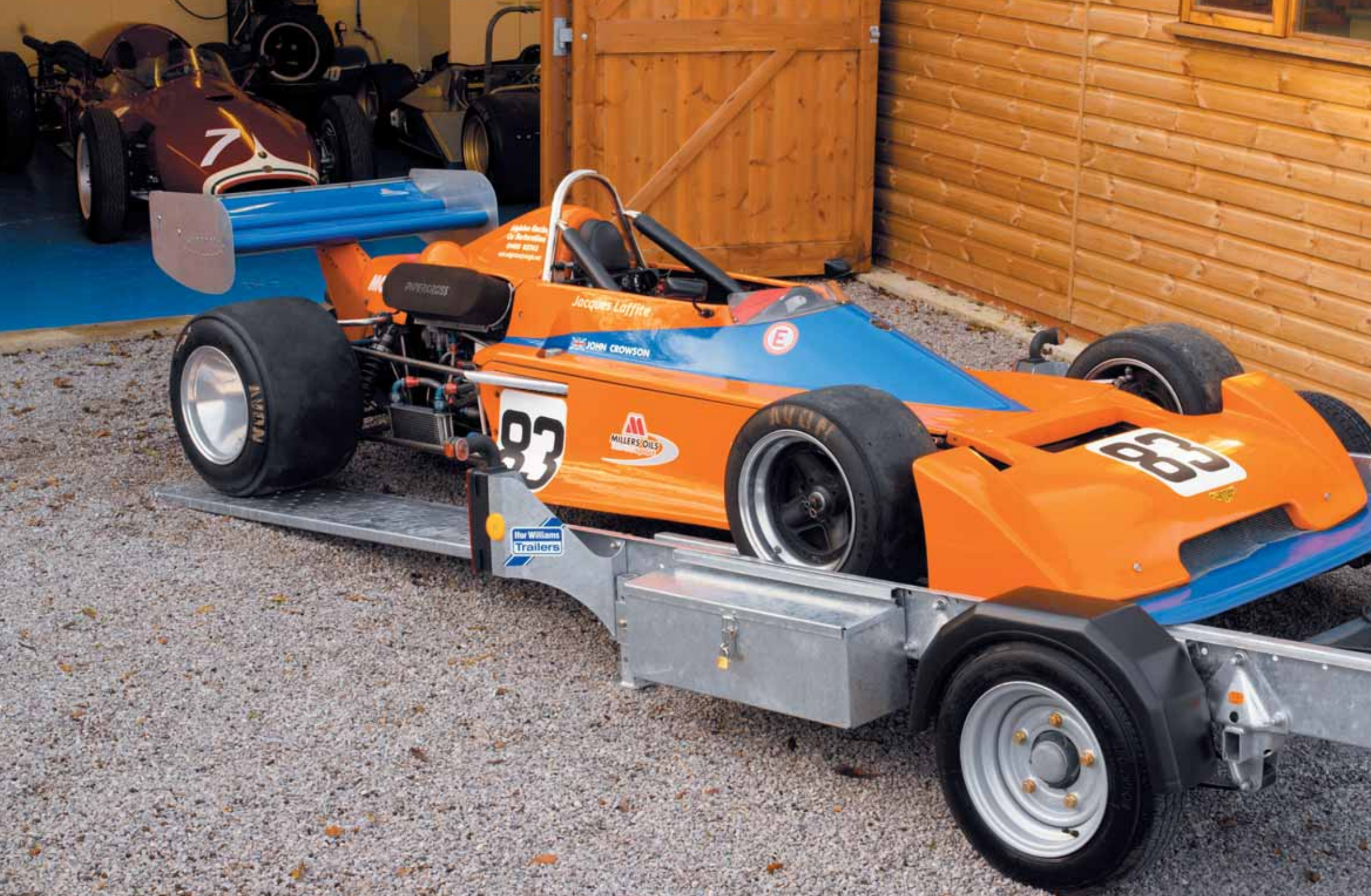
CT136SA avec coffre à outils en mode de chargement dételé (voir page des caractéristiques)
