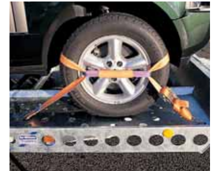
Sangles de roues renforcées
