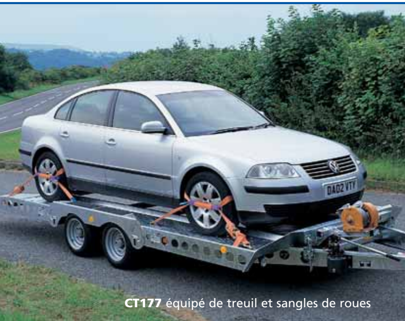
CT177 en position basculante équipé de l'option treuil
